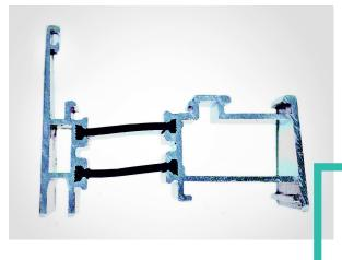
Possibilité de désalignement du profilé aluminium à rupture de pont thermique polyamide
